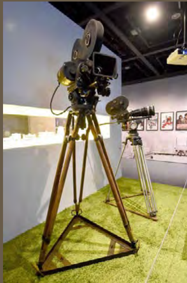
攝影機記錄消失或變化了的地標，並轉化成永恆的光影。圖中的兩部35毫米攝影機，分別為五十年代在香港廣泛使用的米契爾NC（左）及六十年代開始用於拍攝香港電影的阿萊IIC（右）。
